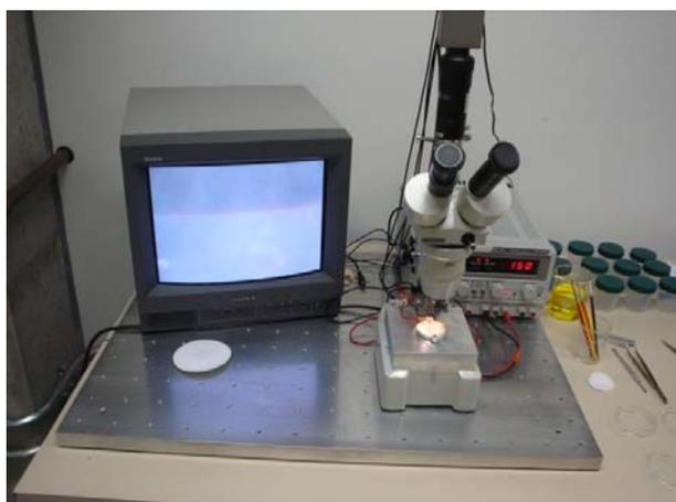
Figura 2: Equipamento para manipulação e corte dos espécimes.
