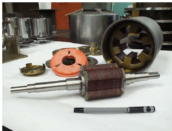
Figura 1 – Motor de relutância chaveado desmontado, detalhe dos pólos salientes no rotor e no estator.
