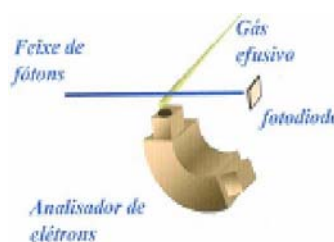
Figura 2: Arranjo experimental de feixes cruzados aplicados na TPES
