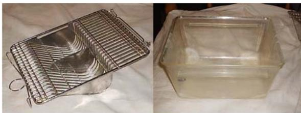
Figura 4. Aspecto da gaiola e da respectiva tampa onde foram realizados os testes de vibração.
