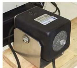
Figura 2. excitador eletrodinâmico (shaker).
