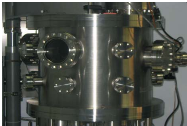
Figura 1- Câmara de deposição do rf-magnetron sputtering .
