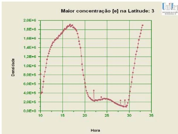
**Figura 7** – Exemplo da variação da densidade eletrônica em função da hora local para a latitude magnética 3° N.
