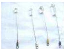
Fig. 3 - Pesos de Calibração
