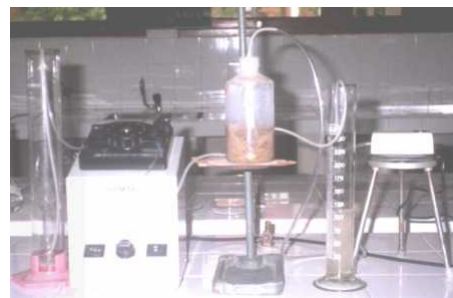
Figura 1: Foto do sistema do processo contínuo para a fermentação acética. Da esquerda para a direita: solução alcoólica, bomba peristáltica, reator contínuo, solução do fermentado e bomba de ar.
