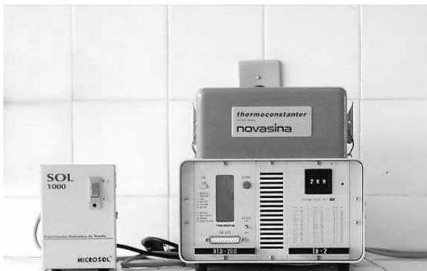
Figura 1 – Equipamento Novasina utilizado para determinação da atividade de água
