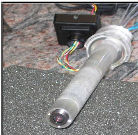
**Figura 1.** Foto frontal do tubo do amnioscópio óptico 2004 desenvolvido.
